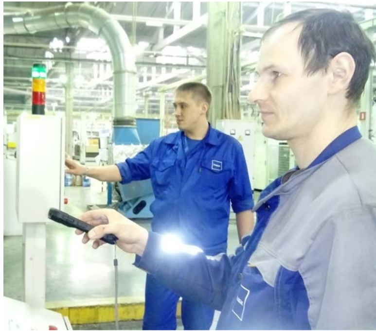
Сканирование штрих-кода при помощи терминала
